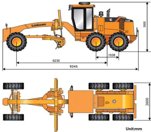
\* со станд.шинами типоразмера 17.5-25/L3, габаритная ширина по шинам 2 600 мм.
